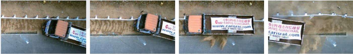
Вес транспортного средства : 8,000кг / Угол столкновения: 15° / скорость : 80км / ч Vehicle weight: 8,000kg / Impact angle: 15 °/ speed : 80km/h
