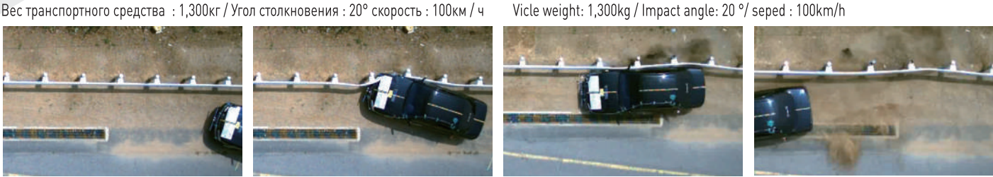
Вес транспортного средства : 1,300кг / Угол столкновения : 20° скорость : 100км / ч Vicle weight: 1,300kg / Impact angle: 20 °/ seped : 100km/h
